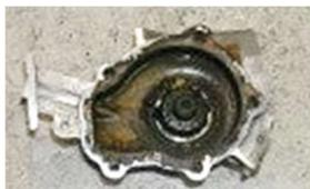
消泡剤の消耗により破損したウォーターポンプ
